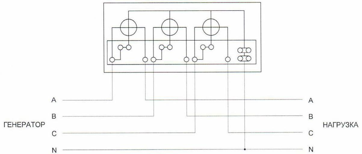
Пример схемы подключения трехфазного электросчетчика через измерительные трансформаторы тока
