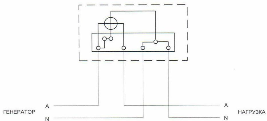
Пример схемы подключения трехфазного электросчетчика непосредственного включения
