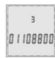
Рис. 12 - Номер счетчика, к которому привязан дисплей
