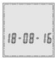
Рис. 8 - Дата последней успешной передачи данных со счётчика на дисплеи
