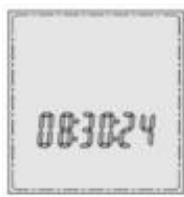
Рис. 7 - Время последней успешной передачи данных со счётчика на дисплеи
